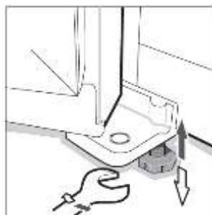
Пластиковые ножки и задние ролики должны касаться пола, чтобы предотвратить перемещение холодильника, вибрацию или шум.
