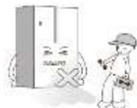
Не устанавливайте холодильник во влажных помещениях или при высокой влажности воздуха. Несоблюдение этого требования приведет к преждевременному износу, более частой работе двигателя и может привести к поражению электрическим током. Устанавливайте прибор в сухом, хорошо проветриваемом помещении.
