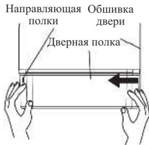
**Снятие:** Возьмитесь руками за обе стороны полки. Отодвиньте ее в сторону без направляющей и вдавите внутрь, как показано на схеме. Нажимайте до тех пор, пока край полки не отделится от двери.
