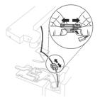
3 Вращайте рычаг петли против часовой стрелки. Поднимите верхнюю петлю из защелки петли.
