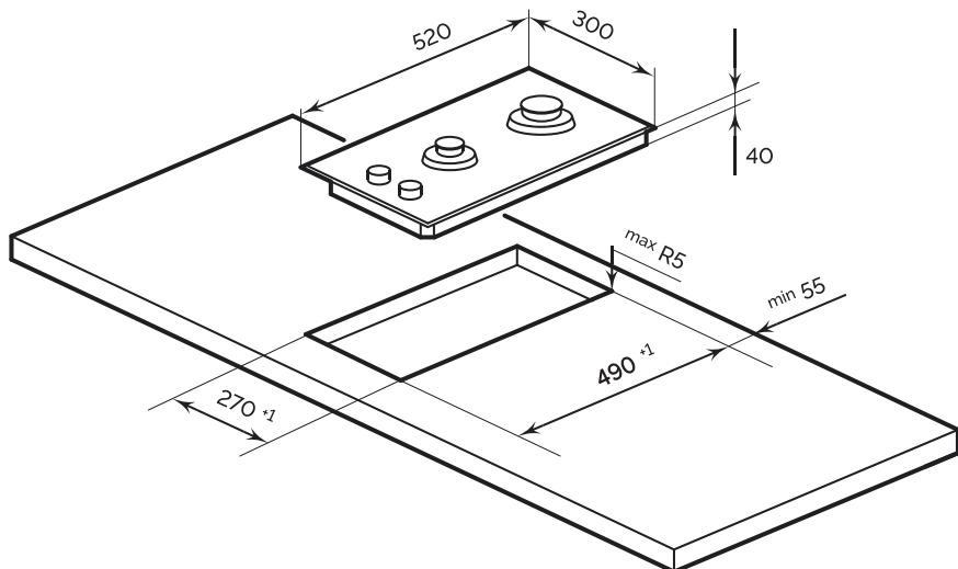
Варочная поверхность встраивается в кухонный шкаф (в зависимости от размера) или столешницу шириной **600 мм** с соблюдением следующих минимальных зазоров:
