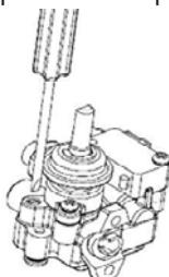
– Открутите винты для того, чтобы открыть корпус варочной поверхности.
