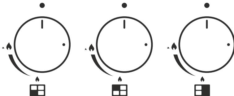
Символ рядом с ручкой на панели управления показывает, какой конфоркой она управляет. Положение конфорки отмечено на символе под ручкой затемненным сектором. Вокруг ручек также отмечена мощность нагрева:
