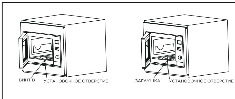
2. Откройте дверцу пеки. Прикрепите пек винтом В к шкафу через установочное отверстие в нижней части рамки. Затем закройте отверстие заглушкой.
