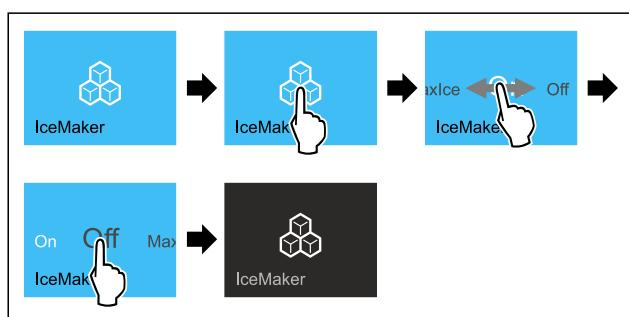
Fig. 55 Пример отображения с активированной функцией IceMaker
