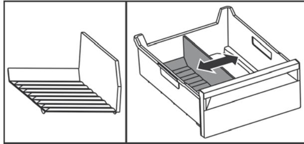
*Fig. 125 Примерное изображение разделителя отделения для льда*
