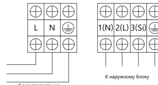
Клеммный терминал наружного блока
