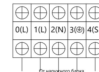
Клеммный терминал наружного блока
