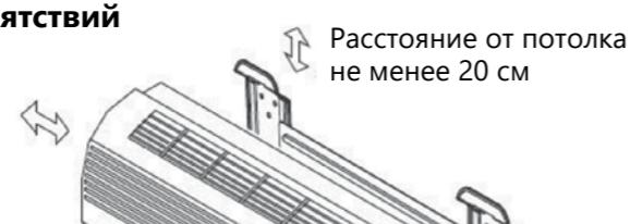
Поверхность стены, на которой устанавливается внутренний блок, должна быть гладкой и ровной, конструкция стены должна выдерживать нагрузку не менее 60 кг.
