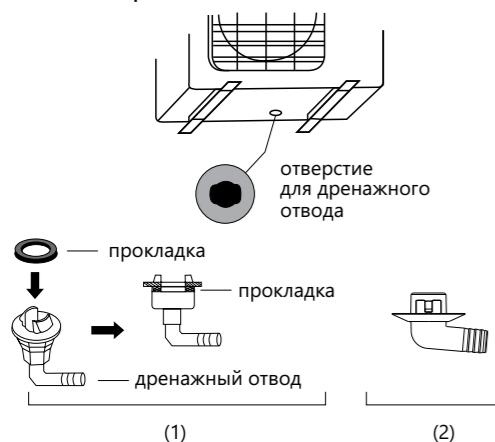
**Примечание:** изображение конструкции дренажного патрубка приведено для справки. Конструкция дренажного патрубка вашего кондиционера может отличаться (например, может отсутствовать резиновая прокладка)
