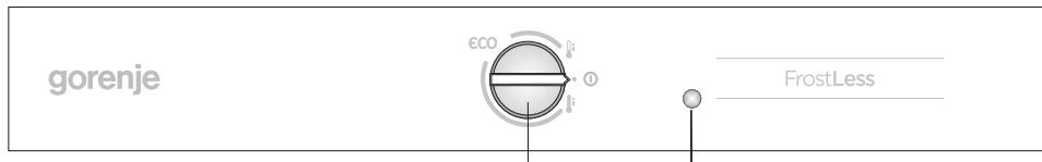
**A Переключатель ВКЛ./ВЫКЛ. прибора, установки температуры и режима ЕСО
