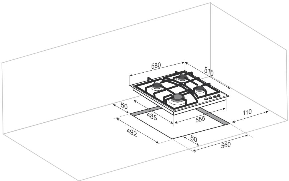
Данный прибор должен быть встроен в шкаф кухонного гарнитура или столешницу толщиной 300 мм, при этом должны быть соблюдены требования в отношении минимальных расстояний:
