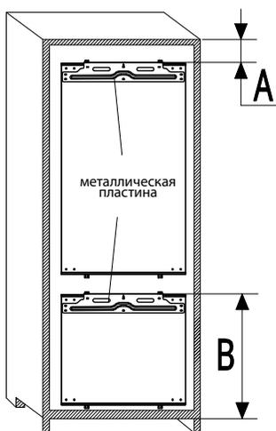
6. Навесьте фасады на двери холодильника. С помощью отвертки T20 и винтов отрегулируйте верхний и нижний зазоры между фасадом и дверцей. Поворотом гаек с помощью ключа на 13 отрегулируйте передний и задний зазоры между фасадом и дверцей.
