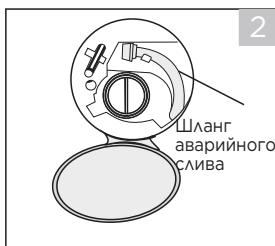
Выньте шланг аварийного слива, вытащите заглушку
