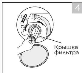
Откройте крышку фильтра, повернув против часовой стрелки
