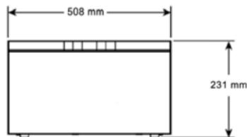
Размеры холодильников приведены на иллюстрации. При выборе места для встраивания учитывайте необходимость отвода тепла от задней части холодильника. Для предотвращения сбоев в работе не используйте слишком длинные провода питания.
