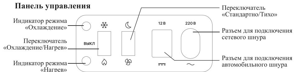
**Переключатель «Охлаждение/Нагрев»** позволяет выбрать режим «Охлаждение» или «Нагрев» или выключить прибор. При переводе переключателя в верхнее положение включится режим «Охлаждение» и загорится **индикатор режима «Охлаждение»**. При переводе переключателя в среднее положение прибор выключится, индикаторы не будут гореть. При переводе переключателя в нижнее положение включится режим «Нагрев» и загорится **индикатор режима «Нагрев»**.
