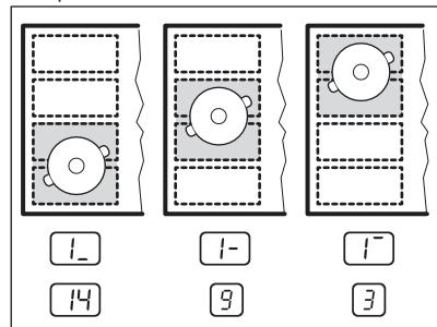
Мощность нагрева для каждого положения можно задавать отдельно. Варочная панель запомнит настройки мощности нагрева и использует их при следующем включении функции.
