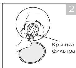
Откройте крышку фильтра, повернув против часовой стрелки
