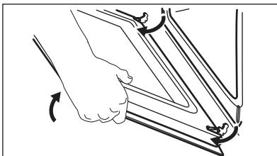
**Шаг 4** Положите дверцу на устойчивую поверхность, подложив мягкую ткань, и отожмите стопоры, чтобы снять внутреннюю стеклянную панель.
