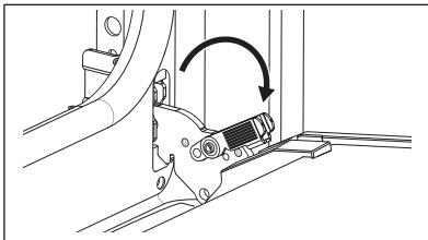
**Шаг 3** Прикройте дверцу наполовину, т.е. до первого фиксируемого положения. Затем вытяните дверцу вверх и вперед, чтобы высвободить ее из гнезда.
