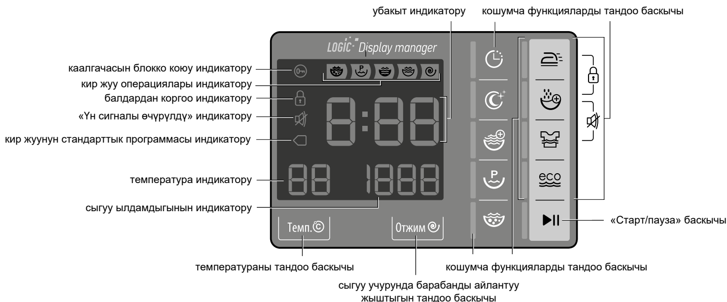
3-сүрөт – Индикация зонасы жана башкаруу баскычтары
