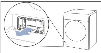
5. Осторожно выньте фильтрующую прокладку из крышки теплообменника.
