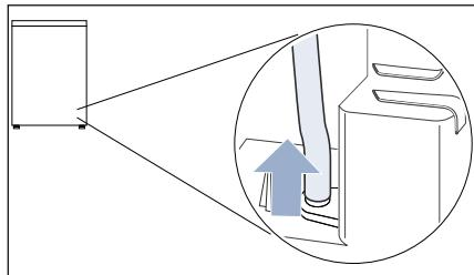
**Указание:** На момент поставки прибора шланг для конденсата закреплён на штуцере.
