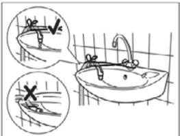
**i** При сливе воды убедитесь, что пластиковая направляющая неподвижна, а сливной шланг не погружен в воду. Грязная вода может попасть обратно в устройство.
