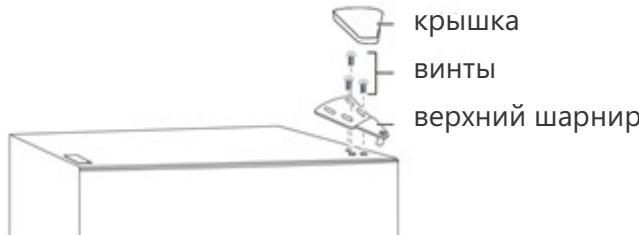
2. Снимите дверь морозильной камеры.
