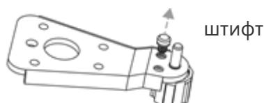
5. Вставьте штифт в левое отверстие на нижнем шарнире, затем закрепите вал с помощью шайбы и гайки.
