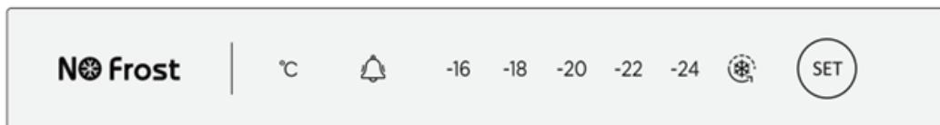
Температура может быть отрегулирована путем нажатия клавиши «SET». Каждый раз, когда нажимается клавиша «SET», индикатор текущего режима светится, пока загорается индикатор следующего режима. Если в течение 5 секунд не выполняется ни одна из операций с клавишой, указанная настройка режима фиксируется. После того как настройку подтвердили, температура будет немедленно контролироваться в соответствии с настройкой режима.
