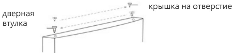
17. Удалите винт, который крепит крышку отверстия для винта шарнира в верхней левой части корпуса, снимите крышку и закрепите крышку в верхней правой части корпуса.
