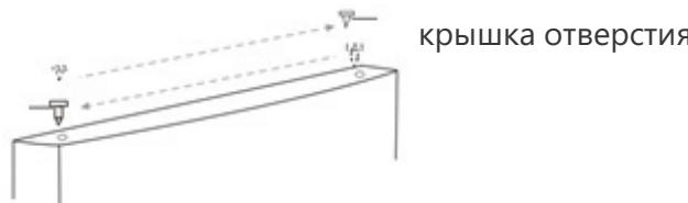
10. Удалите винт, который крепит крышку отверстия для винта шарнира в верхней левой части корпуса, снимите крышку и закрепите крышку в верхней правой части корпуса.
