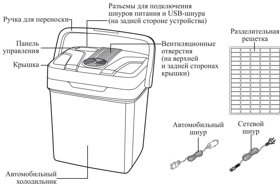
**Вентиляционные отверстия** для циркуляции воздуха расположены на верхней и задней сторонах крышки. Вентилятор с внутренней стороны крышки обеспечивает равномерное распределение охлажденного или нагретого воздуха в камере холодильника.
