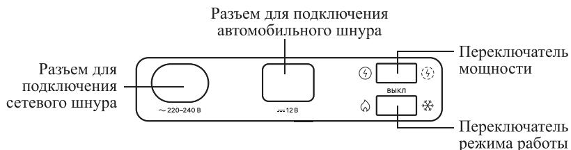
На задней стороне корпуса расположены переключатели режима работы и мощности, а также разъемы для подключения сетевого и автомобильного шнуров. Сетевой шнур предназначен для подключения к сети 220 В. Автомобильный шнур имеет штекер для разъема прикуривателя в автомобиле.
