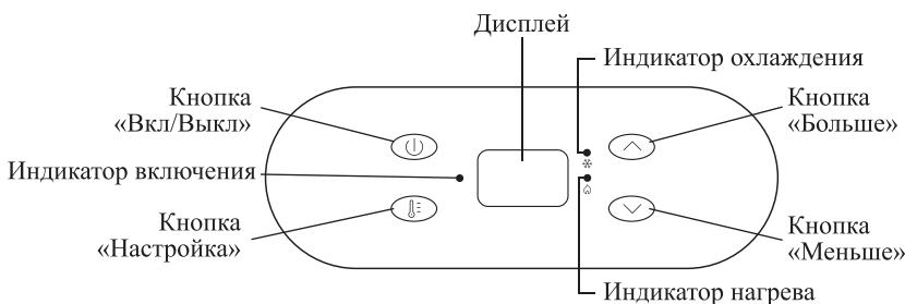
На **дисплее** отображается настраиваемая температура при установке и текущая температура в камере при работе устройства.
