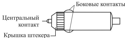
2. Установите новый предохранитель (предохранитель не имеет полярности, поэтому вы можете установить его любым концом внутрь). Технические характеристики предохранителя: 10 A, 250 В, длина 20 мм и диаметр 5 мм.
