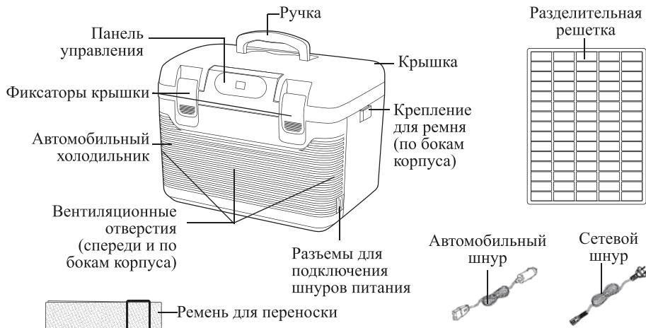
**Вентиляционные отверстия** для циркуляции воздуха расположены на передней стороне корпуса и по бокам. С левой и правой стороны корпуса находятся **крепления для ремня**. Ремень для переноски облегчит транспортировку автохолодильника.
