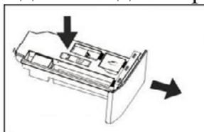
2. Промойте два резервуара для хранения порошкового моющего средства и смягчителя проточной водой и смойте остатки моющего средства.
