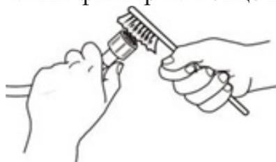
3. Открутите шланг подачи воды на задней панели прибора. Выньте плоскогубцами сетчатый фильтр из клапана подачи воды на задней панели прибора и тщательно очистите его.
