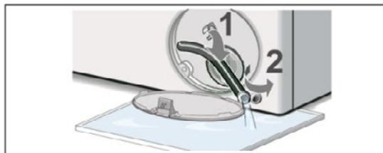
5. Поверните крышку насоса против часовой стрелки, чтобы снять ее. При снятии крышки может вытекать небольшое количество остаточной воды. Очистите внутреннюю часть насоса, удалив весь мусор или посторонние предметы. Удалите все ворсинки, мусор или остатки моющего средства с резьбы крышки насоса и корпуса крышки насоса. Установите крышку насоса на место, плотно закрутив ее. Ручка должна быть расположена вертикально.
