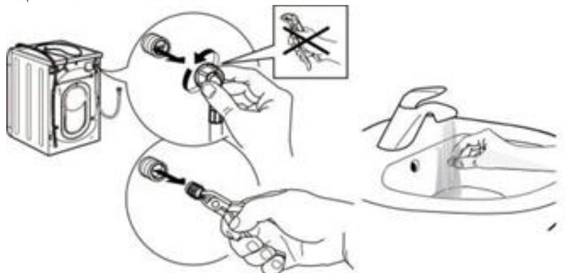
4. Вставьте сетчатый фильтр на место. Подсоедините шланг подачи воды к водопроводному крану и прибору. Не используйте инструмент для подсоединения впускного шланга. Откройте водопроводный кран и убедитесь, что все соединения герметичны.
