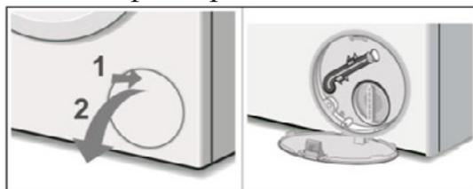
4. Используйте выдвижной сливной шланг, расположенный в отверстии для доступа к насосу, чтобы слить оставшуюся воду в подходящую емкость (можно слить до 20 литров воды). Снимите уплотнительный колпачок со
