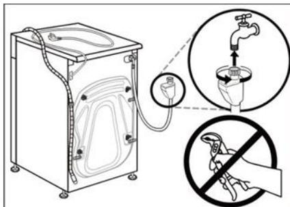
2. Подсоедините другой конец шланга для подачи воды к клапану для подачи воды на задней панели прибора и затяните вручную.
