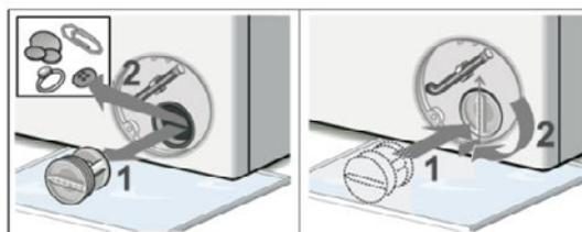
6. Закройте крышку сливного фильтра. Вытрите всю пролитую воду.
