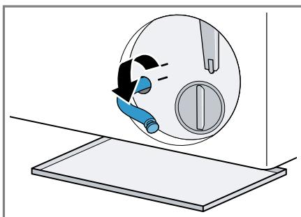
7. **ОСТОРОЖНО - Опасность ошпаривания!** Во время стирки при высокой температуре раствор моющего средства сильно нагревается.
