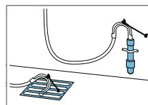
Зафиксируйте и закрепите сливной шланг скобой.
