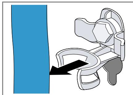
2. Выверните ① и снимите ② винты всех 4 транспортировочных креплений при помощи гаечного ключа на 13.
