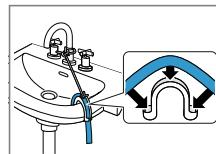
Зафиксируйте и закрепите сливной шланг скобой.
