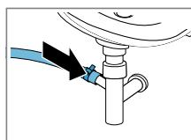
Зафиксируйте соединение хомутом (24-40 мм).
