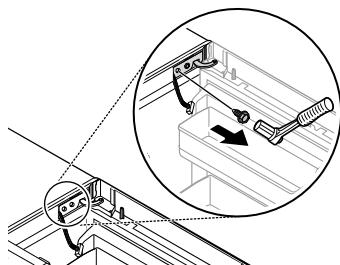
3 Для моделей с панелью управления на дверце холодильника отключите соединитель.
