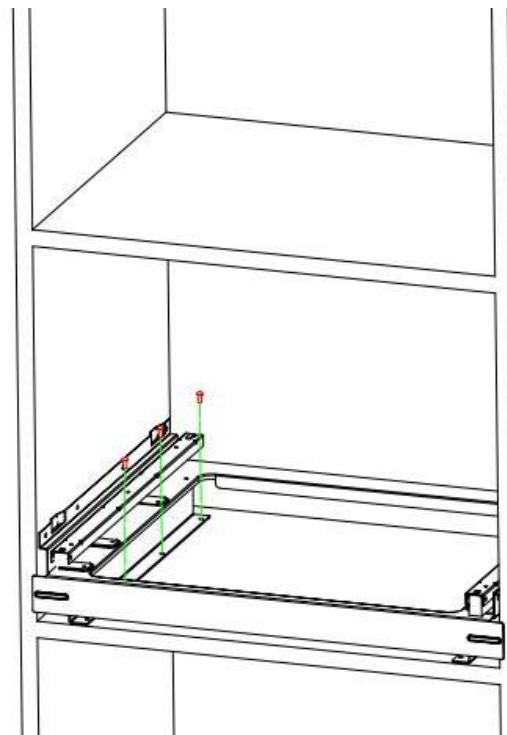
Шаг 2: при монтаже к нижней планке (когда под кофемашиной не располагается никакая другая техника) закрепите соединительный кронштейн винтами.
