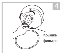
Откройте крышку фильтра, повернув против часовой стрелки
