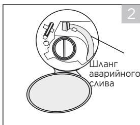
Выньте шланг аварийного слива, вытащите заглушку
