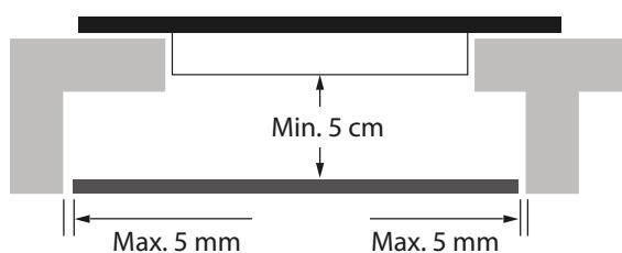
Снаружи варочной панели имеются вентиляционные отверстия. ВЫ ДОЛЖНЫ убедиться, что эти отверстия не заблокированы столешницей, когда Вы устанавливаете варочную панель на место.
