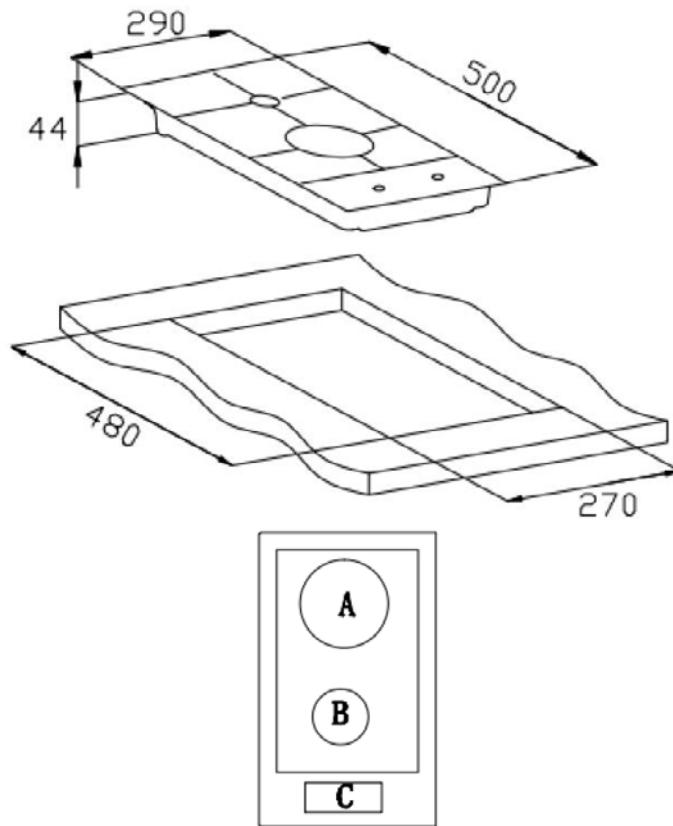
A) 1 x 2.4 кВт горелка повышенной мощности
