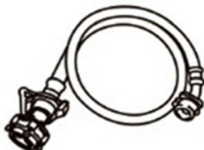
Шланг подачи воды
