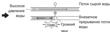
Отрегулируйте давление воды, прикрыв водяной кран.
