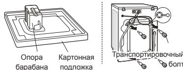
Снимите транспортировочные болты и опоры.
