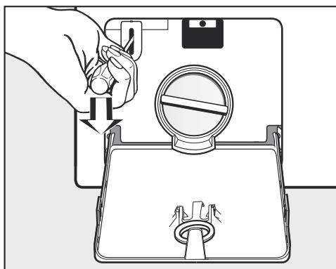
■ Разблокируйте дверцу с помощью отвёртки, потянув язычок блокировки вниз.
