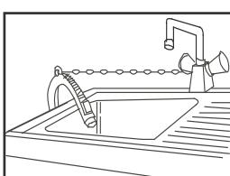
Если в качестве слива используется раковина, гофрированный сливной шланг должен быть расположен над отверстием перелива для предотвращения скопления воды. Для более надежного крепления на борту раковины используйте изогнутый держатель.
