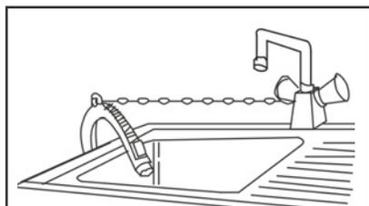
Если в качестве слива используется раковина, гофрированный сливной шланг должен быть расположен над отверстием перелива для предотвращения скопления воды. Для более надежного крепления на борту раковины используйте изогнутый держатель.
