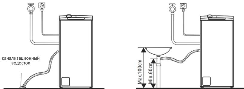
**При подключении слива стиральной машины непосредственно в канализацию, выход должен быть снабжён гидрозатвором для предотвращения самослива!**
