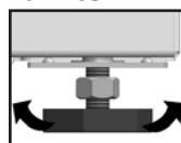
После того как прибор будет установлен на место предполагаемого использования, отрегулируйте его по уровню с помощью инструмента, затем зафиксируйте положение ножек с помощью контргайки. Стиральную машину следует устанавливать на твердой и ровной поверхности.
