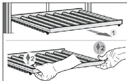
Чтобы извлечь полку из прибора, полностью выдвиньте телескопические направляющие (1), затем поднимите полку вверх (2) и снимите с направляющих. При снятии полки может ощущаться некоторое сопротивление из-за фиксации полки спереди штифтом. Следите, чтобы не повредить уплотнитель двери.
