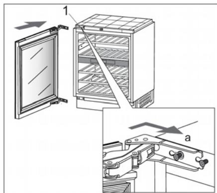
12. Навесьте дверь на винты (1) в верхней и нижней части и сдвиньте в направлении стрелки (а).
