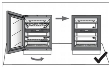
4. Края корпуса и двери должны быть параллельны.
