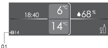
Когда значение счетчика остаточного ресурса угольного фильтра станет равно 0, на дисплее состояния начнет мигать значок угольного фильтра (01).
