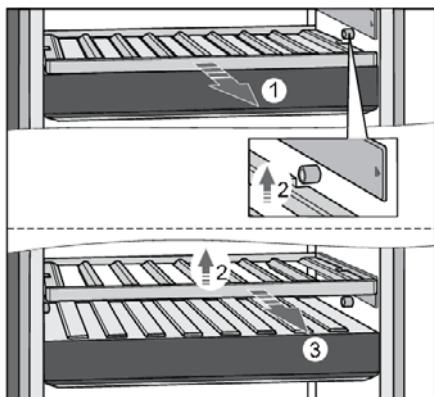
Чтобы снять полку, потяните ее на себя (1), пока пазы по бокам полки не совместятся с двумя ограничителями (слева и справа) на стенках прибора. Затем поднимите полку (2) и извлеките из прибора (3). Будьте осторожны, чтобы не повредить уплотнитель двери.
