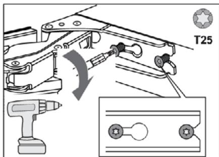
13. Затяните винты. Винты должны быть затянуты с моментом затяжки 6,2 Нм.
