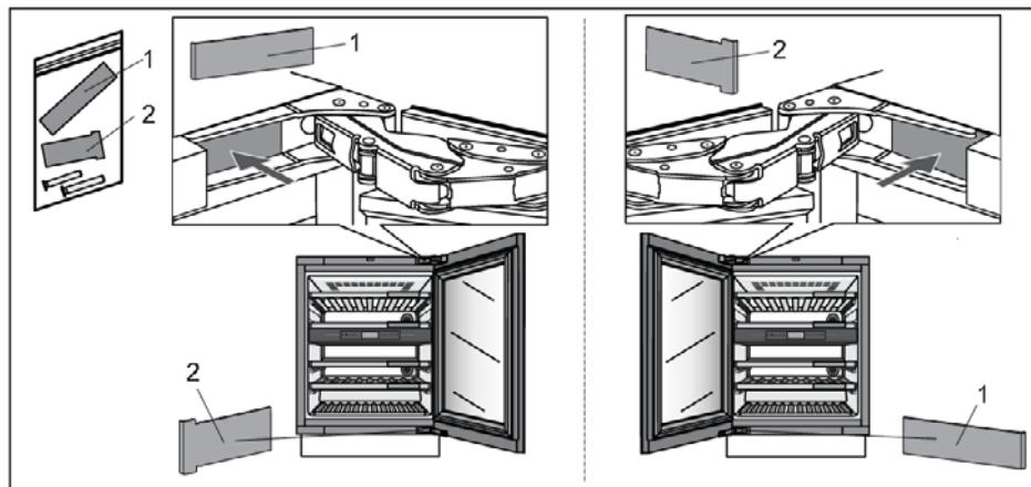
14. Если прибор установлен таким образом, что открывание двери на  $115^{\circ}$  невозможно, угол открывания можно ограничить до  $90^{\circ}$ . В этом случае установите ограничители двери (1 и 2) в соответствии с направлением открывания дверцы прибора. Аккуратно откройте дверь не более чем на  $90^{\circ}$  и вставьте ограничитель в отверстие в верхнем шарнире. Повторите действия с нижним шарниром. При установке ограничителя в шарнир можно использовать небольшой молоток.
