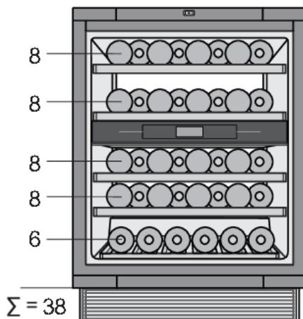
Стандартная конфигурация прибора позволяет хранить до 38 бордоских бутылок.
