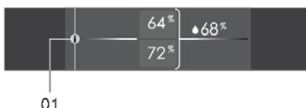
Влажность нельзя регулировать, можно только контролировать. Сверху отображается значение для ЗОНЫ А, снизу — для ЗОНЫ В. Справа отображается средняя влажность. На вкладке «Информация» (01) представлена дополнительная информация о том, как влажность влияет на вино.
