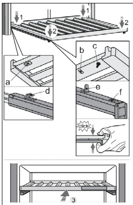
Чтобы установить полку на направляющие, используйте углубления (а, б) и штифт (с) с задней и передней стороны полки.
