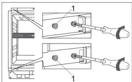
8. Вкрутите винты (1) в отверстия в верхней и нижней части с левой стороны корпуса, но не закручивайте полностью.
