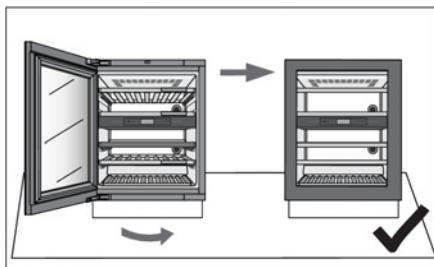
14. Закройте дверь и проверьте, чтобы она была выровнена с корпусом. Края корпуса и двери должны быть параллельны.
