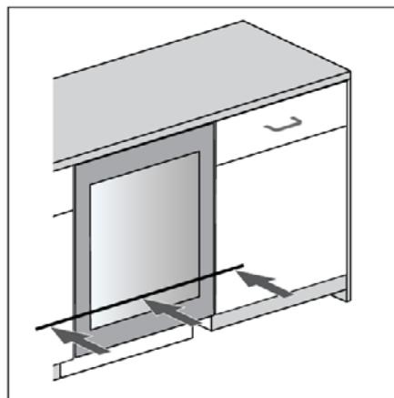
5. Задвиньте прибор в нишу так, чтобы поверхность его двери была выровнена с дверцей кухонного шкафа.
