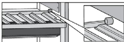
Полку можно частично выдвинуть (и извлечь) из прибора. Чтобы полка не упала, ограничили на стенках прибора предотвращают ее полное выдвижение и извлечение.
