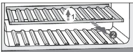
Нижняя деревянная полка предназначена для хранения бутылок в зоне компрессора. Это отделение подходит для длительного хранения вина, особенно предназначенного для созревания без чрезмерной вибрации и лишних перемещений. Чтобы извлечь нижнюю полку из прибора, поднимите ее (1) и извлеките (2). Будьте осторожны, чтобы не повредить уплотнитель двери.
