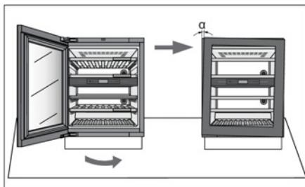
15. Если дверь не выровнена с корпусом (угол  $\alpha$  не равен  $0^\circ$ ),
