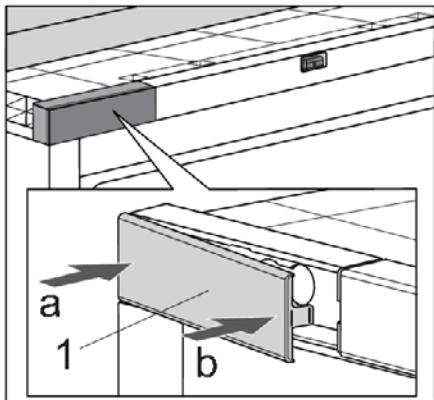
8. Установите на место крышку держателя верхнего шарнира (1). Сначала нажмите в направлении стрелки а, а затем — б.
