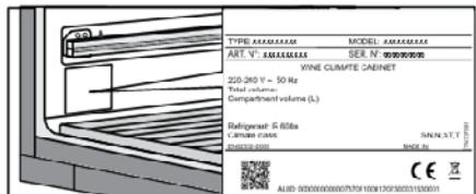
Устанавливать прибор следует в сухом, хорошо проветриваемом помещении. Допустимый диапазон температуры окружающей среды зависит от климатического класса прибора, который указан в заводской табличке.
