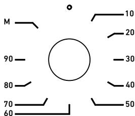
Позволяет установить время приготовления пищи. Вы можете выбрать температуру и тип приготовления, а также отрегулировать время приготовления, поворачивая его по часовой стрелке. По истечении времени, он подает предупреждение звуковым сигналом. При желании можно начать приготовление в режиме M, выбрав температуру и тип приготовления, не задавая время.
