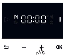
Сначала выберите минуты с помощью кнопок -/+ , затем активируйте часы нажатием на кнопку OK
