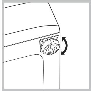
2. После установки машины на место отрегулируйте ее устойчивое положение путем вращения передних ножек (см. рис.). Для этого сначала ослабьте контргайку, после завершения регулировки затяните.
