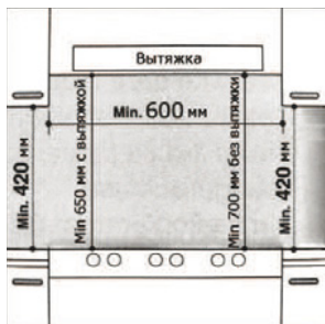
Рис. 4. Расстояние от поверхности прибора до навесных шкафов
