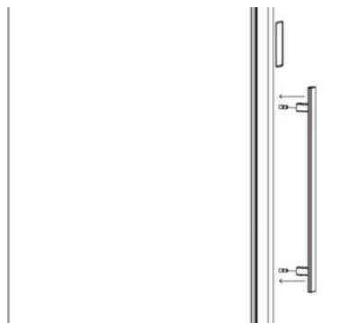
Шаг 3: Затяните винты с помощью шестигранной отвертки, не прилагая больших усилий
