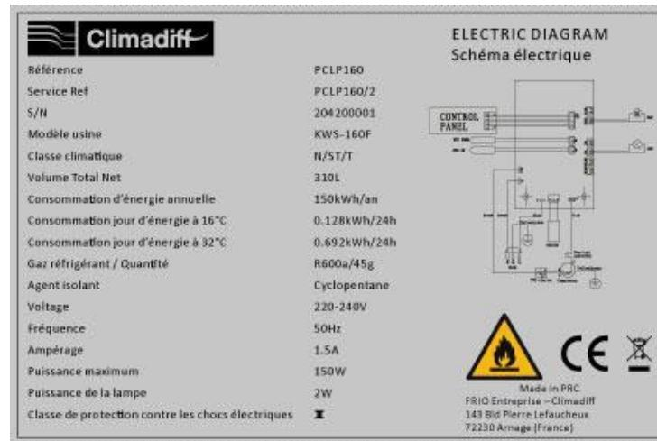
Заводская табличка, прикрепленная к внутренней или задней стенке прибора (в зависимости от модели), содержит всю информацию, относящуюся к вашему прибору.
