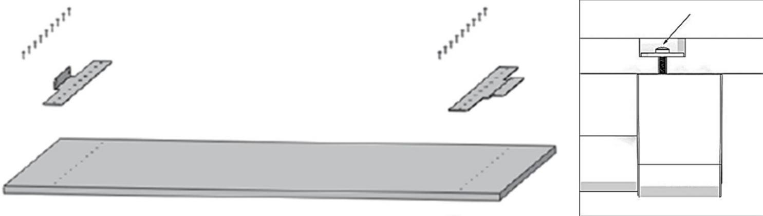
Установите крепежную сборку на декоративную панель дверцы морозильного отделения с помощью винтов. Затем закрепите три металлические скобы винтами (см. Рис). При креплении ручки двери, убедитесь, что части винтов, держащих ручку, не возвышаются над плоскостью декоративной панели.
