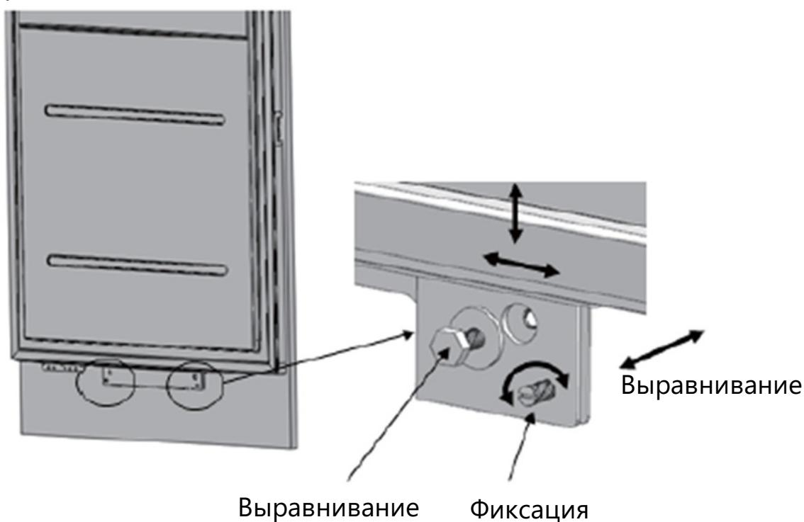
Установите скобы по углам дверцы и прикрепите их к дверце и декоративной панели при помощи винтов. Закройте петли специальными пластиковыми заглушками.
