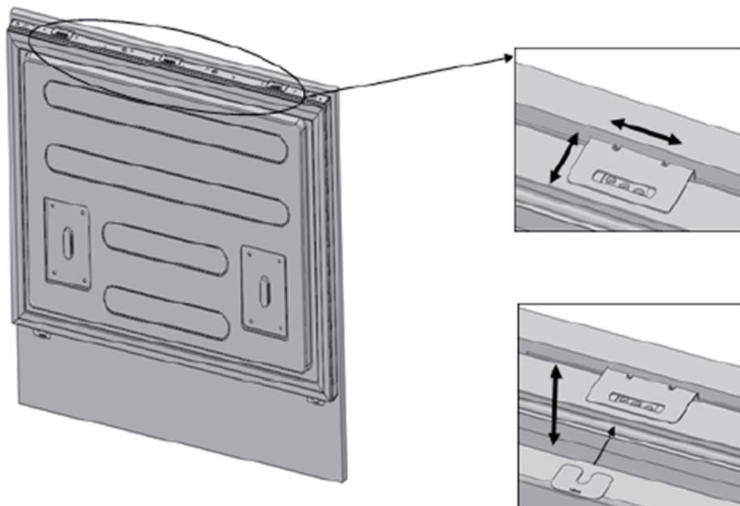
Прикрепите две нижние скобы к декоративной дверце винтами, затяните винты. Закройте скобы пластиковыми заглушками.
