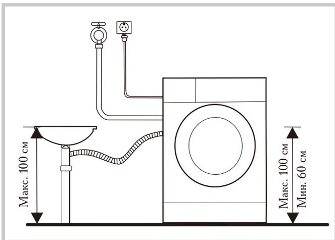
Убедитесь, что сливной шланг надежно закреплен на задней стенке корпуса на высоте не менее 60 см. Это необходимо, чтобы избежать преждевременный слив воды в процессе стирки. Вы также можете установить на слив обратный клапан (приобретается отдельно).
