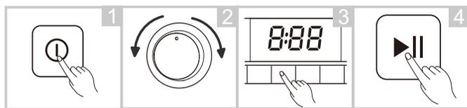
1. Включите машину нажатием кнопки **Вкл./Выкл.**
