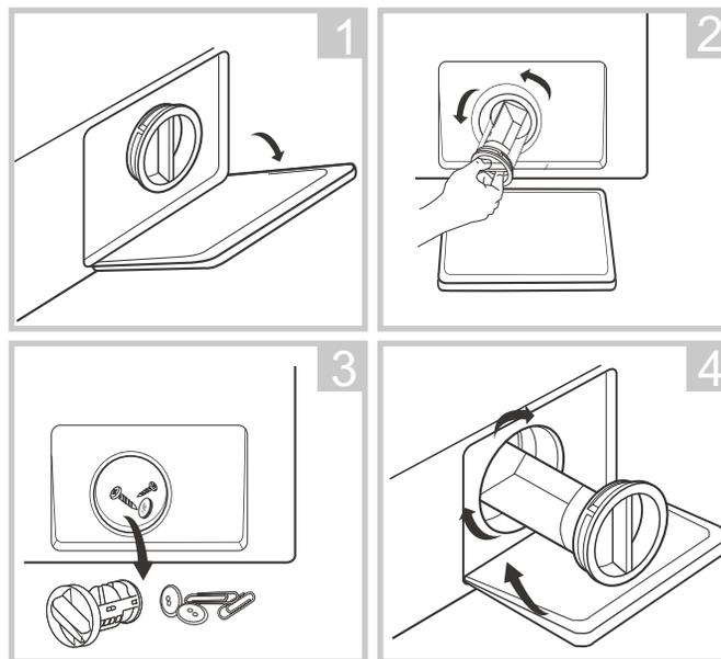
1. Откройте крышку отсека с фильтром. Поставьте под отсек небольшую емкость для сбора вытекающей воды.
