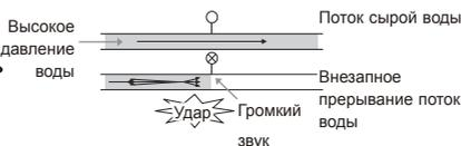
Отрегулируйте давление воды, прикрыв водяной кран.
