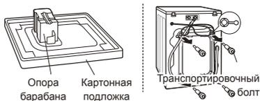
Снимите транспортировочные болты и опоры.
