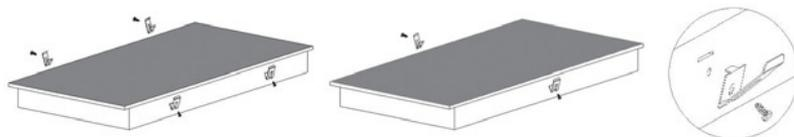
**Befestigung des Kochpanels auf dem Küchenmodul:** Stecken Sie das Kochpanel ins Küchenmodul / in die Arbeitsplatte ein, wie es in Abbildungen unten gezeigt ist; dabei wird das Kochpanel mit den seitlichen Klammern fest fixiert.
