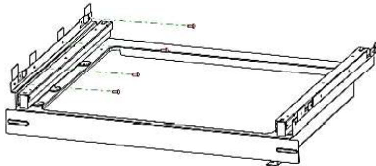
Б. Метод крепления к полке снизу.
