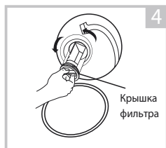
Откройте крышку фильтра, повернув против часовой стрелки
