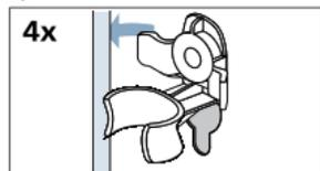
б) Снимите втулки.
