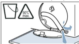
4. Осторожно отвинтите крышку насоса; теперь оставшаяся в насосе вода может вытечь. Очистите внутреннюю часть, резьбу крышки насоса и корпус насоса. Рабочее колесо сливного насоса должно свободно вращаться.
