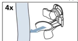
2. Отвинтите и снимите все четыре транспортировочных болта.
